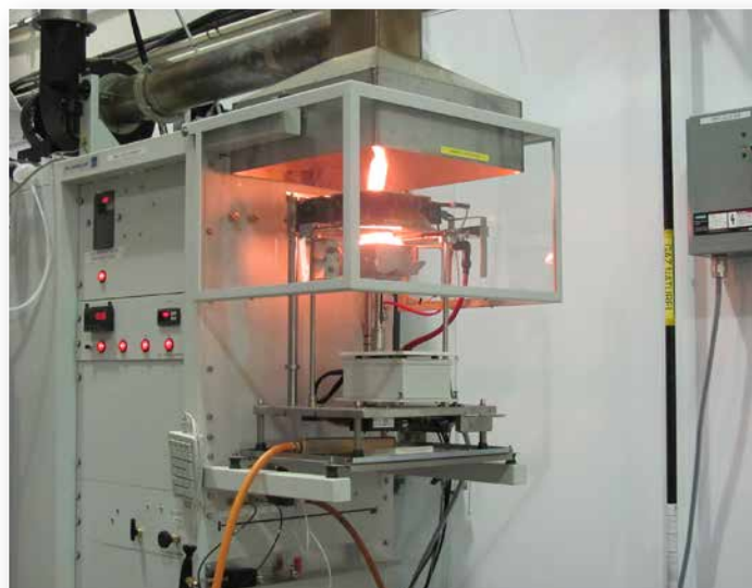
Utilisation d'un calorimètre à cône au centre de recherches FPInnovations. Il s'agit d'un dispositif clé utilisé dans le secteur de l'essai au feu pour étudier le comportement du feu sur des échantillons de matériaux. Photo utilisée avec l'autorisation de FPInnovations.
